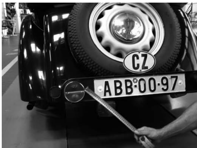
Obr. č. 3. Na co se často zapomíná, je minimální vzdálenost 100 mm zadní mlhové svítilny od brzdové svítilny.
