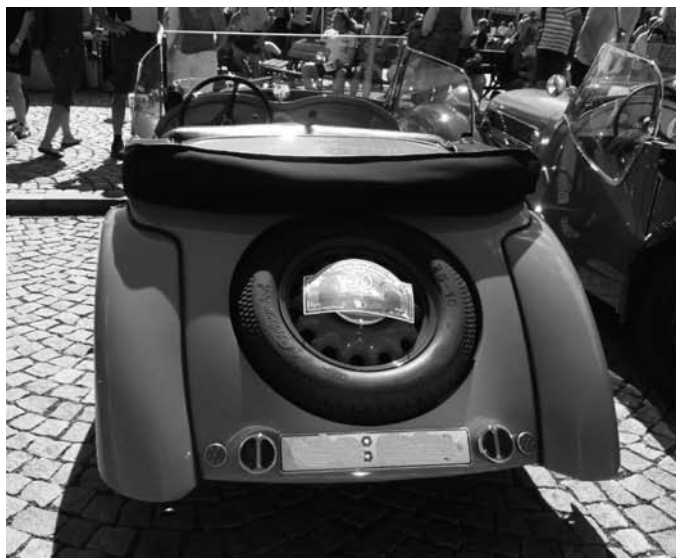
Obr. č. 1. Zde není dodržena podmínka svislé roviny kolmé k rovině vozovky u odrazek, sdružených svítilen a tabulky s registrační značkou. Vzdálenost mezi obrysovými světly je menší než 600 mm. A mlhovka....
