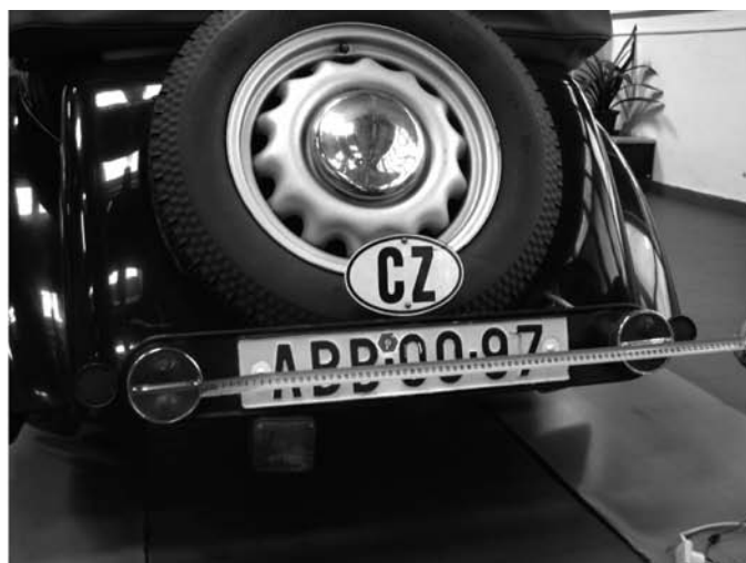
Obr.č. 4. Minimální vzdálenost mezi zadními obrysovými svítilnami je 600 mm.
